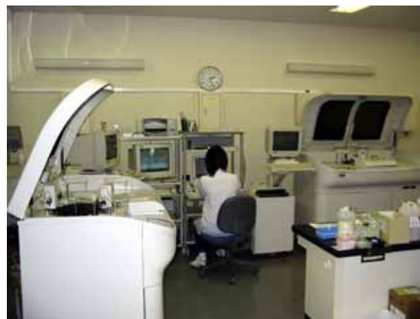
生化学自動分析装置(日立7170)で43項目の検査をしています
